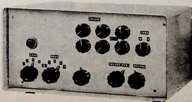
Afb. 22 - De kast van de voorversterker, waarin de PU-versterker is ondergebracht.
